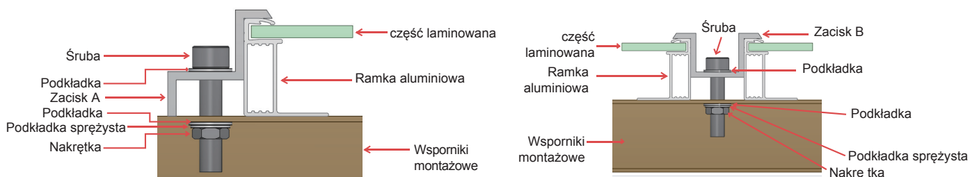
Rysunek 5 Montaż zacisków modułu jednofazowego
